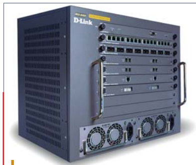
Рис. 1. Модульный коммутатор 3-го уровня для корпоративных приложений DES-6300
