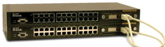
Рис. 2. Стековый коммутатор 3-го уровня DES-3326S
